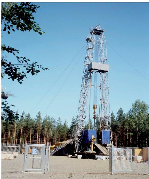
Рис. 1. Расположение исследовательской скважины Оутокумпу в Финляндии (слева) и буровой станок, последняя глубина – 2516 м (Оутокумпу, июль 2004).
