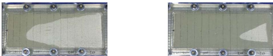
Рис.3. Типовые картины фронта течения вязкой жидкости в различные моменты пропитки под давлением с суммарным зазором по обоим краям пластины 0,5 мм
