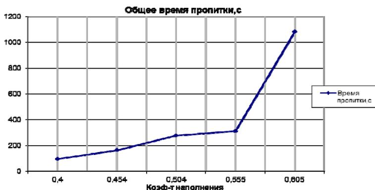
Рис.1. Зависимость общего времени пропитки от коэффициента наполнения
