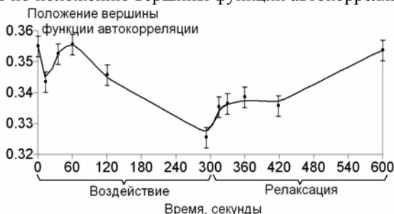
Рис. 1. Изменение положения вершины функции автокорреляции при воздействии на бензин лазерным излучением с интенсивностью  $15 \text{ Вт/см}^2$
