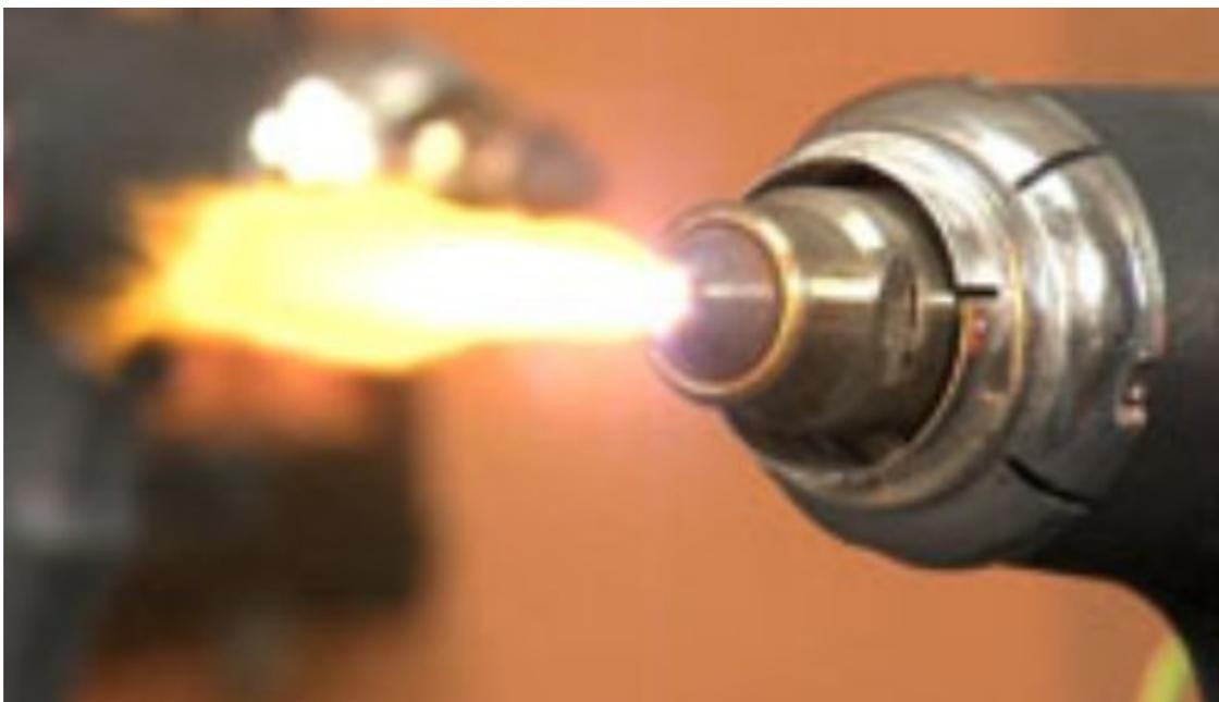
Рис.1 Фрагмент горелки и факел пароводяного плазмотрона «Мультиплаз»
