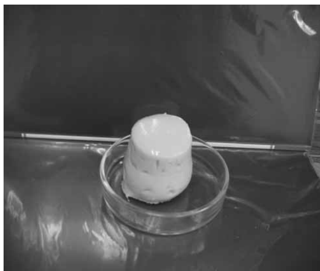
Рис. 2. Внешний вид композиции на основе смолы, полимера и сшивателя.
