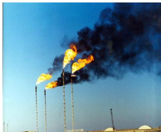
**Рис. 1.** Сжигание на факелах попутного газа
