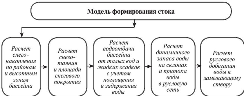
**Блок-схема гидролого-математической модели формирования стока**
