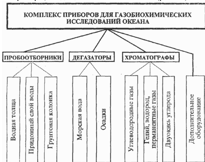
Рис. 10. Состав комплекса приборов для количественных газобиогеохимических исследований океана.
