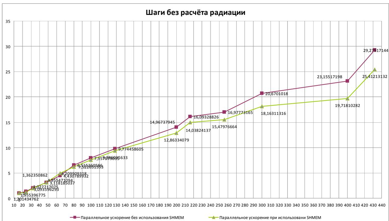
**Рис. 4. Параллельное ускорение модели на вычислительной системе SGI Altix 4700 для шагов, в которых не производится расчёт радиации.**
