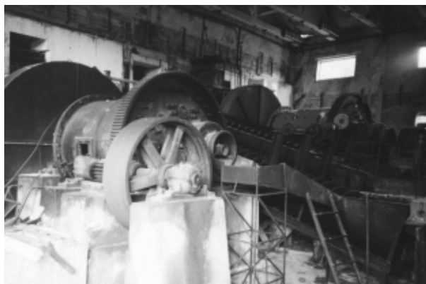
Рис. 3. Шаровые мельницы для тонкого измельчения молибденитовой руды на опытной обогатительной фабрике Харбейского рудника. Фото В. В. Григорьева
