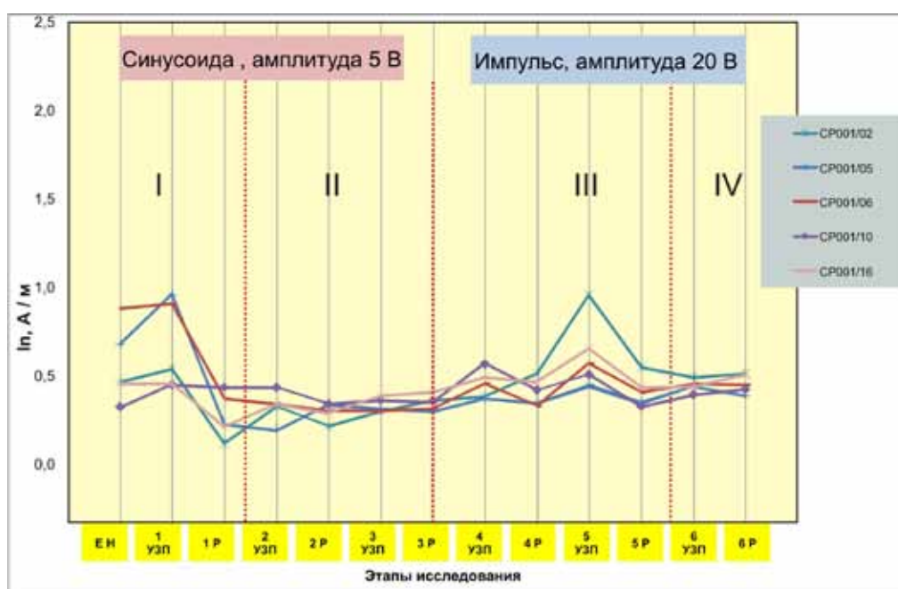
Рис. 3. Графики изменения намагниченности при использовании монохромного и импульсного сигналов с различными значениями амплитуды.
