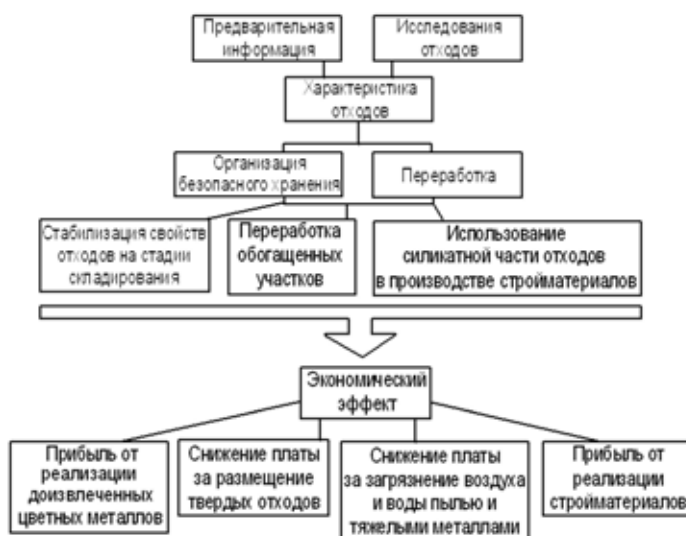
Рис. 3. Система управления отходами горнопромышленного комплекса и слагаемые экономического эффекта [1].
