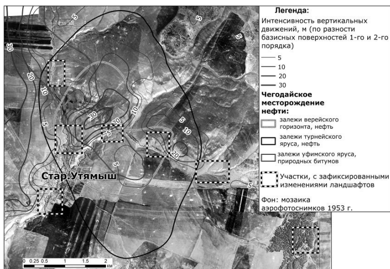
Рис. 1. Связь неотектоники и современной геодинамики с нефтеносностью (на примере Чегодайского месторождения)
