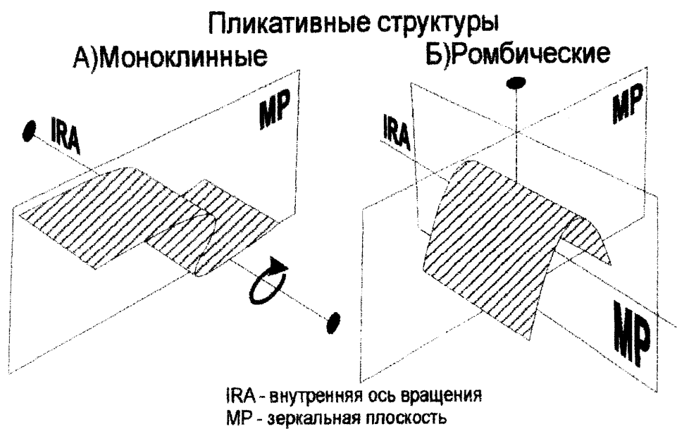
Рис. 2. Моноклинные (слева) и ромбические (справа) пликативные структуры и их элементы симметрии (в интерпретации автора).
