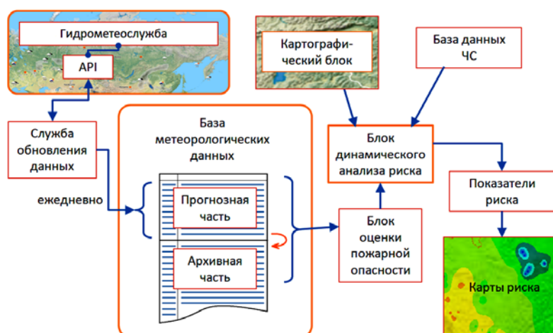
Рис. 2. Схема работы автоматизированной системы динамического анализа риска лесных пожаров
