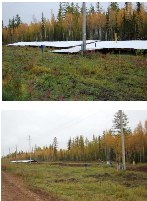
Рис. 2. Экспериментальная (с навесом) и контрольная (без навеса) площадки с термометрическими скважинами на линейной части ВСТО-1, км 1704
