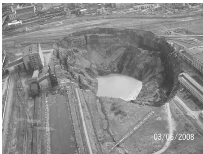
Рис. 3. Техногенный провал на Березниковском калийном руднике 28 июля 2007 г.
