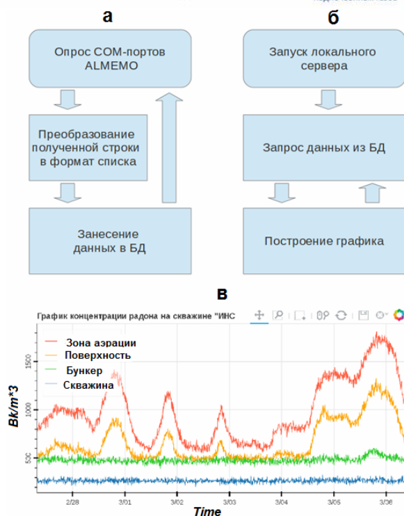
Рис. 3. Блок-схема работы программы для автоматизированной регистрации (а) и визуализации (б) подпочвенных газов, экранная форма графиков концентрации радона за период 27.02-8.03.2017 г. (в)
