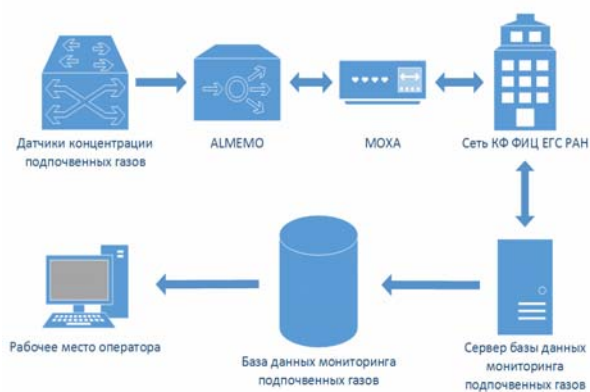
Рис. 2. Блок-схема работы автоматизированного аппаратно-программного комплекса с целью мониторинга концентрации подпочвенных газов в пункте ИНС
