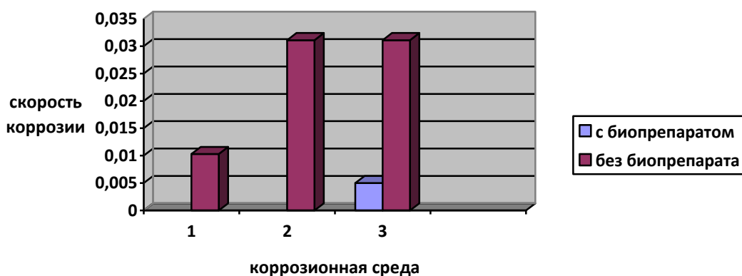
Зависимость скорости коррозии от наличия в среде биопрепарата
