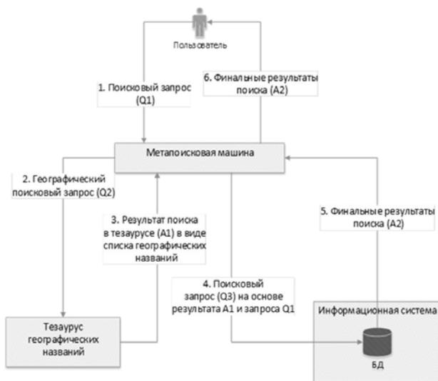
Рис.1 – Поиск с использованием тезауруса географических названий
