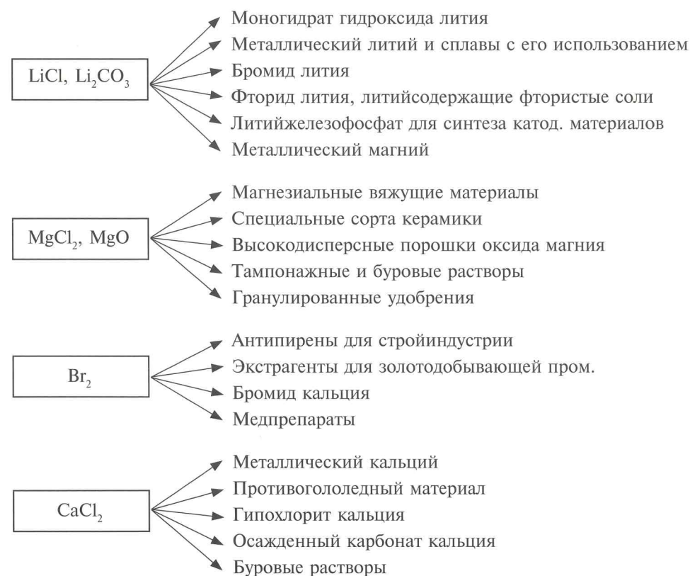
Рис. 5.11. Получаемые соединения и материалы с их использованием при переработке рассолов хлоридного кальциевого типа.
