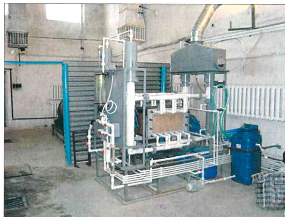
Рис. 5.2. Промышленный модуль получения хлора диафрагменным электролизом раствора поваренной соли.
