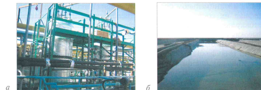
Рис. 4.4. Опытно-промышленный сорбционно-десорбционный обогатительный модуль (а) и накопительный бассейн для литиевого концентрата (б).
