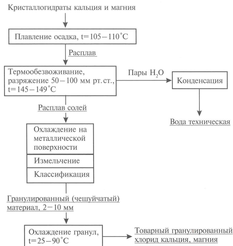
Рис. 5.7. Технологическая схема получения гранулированного хлорида кальция, магния из кристаллогидратов.
