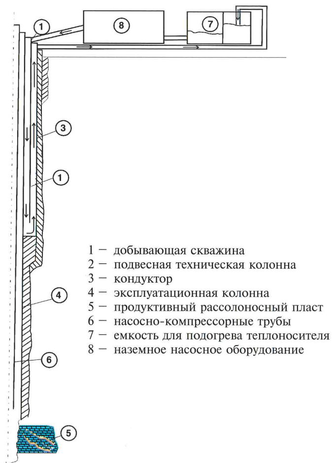
Рис. 2.6. Схема замкнутого цикла на оборотном теплоносителе [97].
