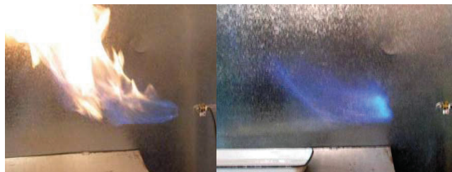
Рисунок. 3. Фотографии пламени: без подачи дополнительного метана через форсунку (слева) и с подачей метана через форсунку (справа)
