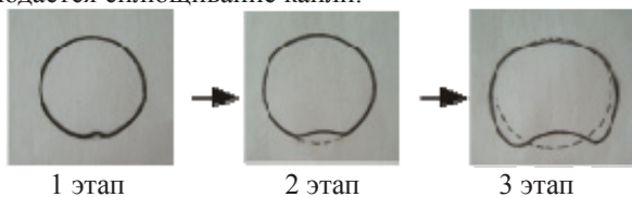
Рисунок 1: Стадии деформации капли при числах Рейнольдса Re < 1
