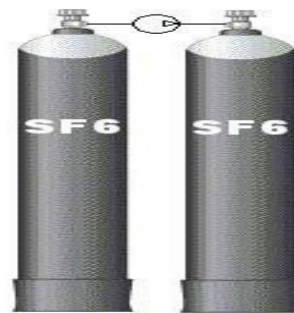
Рисунок 2. Простейшая схема регенерации элегаза.
