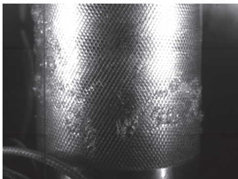
Рисунок 1: Теплоотдающая поверхность с трехмерной структурой ромбовидной формы.
