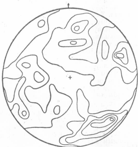
Рис. 4. Синоптическая диаграмма трещиноватости Слюдянского месторождения. Построение на равноплощадной сетке; 182 частных концентрации; изолинии 1—2—3—4—5%.
