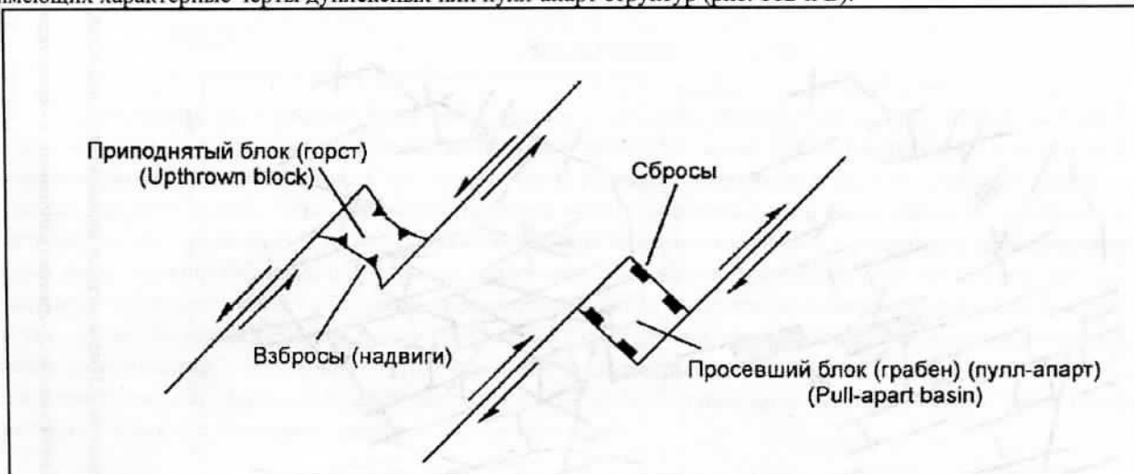
Рис. 10. Формирование дуплекса растяжения в зоне левого сдвига (Twiss, Moores, 1992).
