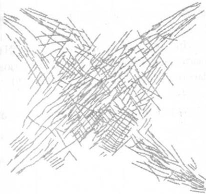
Рис.6. Интегральная схема разрывов, сформированных в слое имитирующем платформенный чехол в течении второго и третьего этапов
