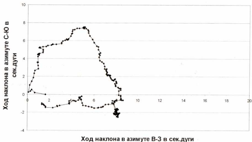
Рис. 5 Изменения векторной диаграммы хода наклонов на станции Талая с 1985 г. по конец 2002 г. Релаксация после 25.02.1999.
