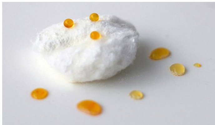
Капли масла на поверхности ваты, покрытой супергидрофобной самоочищающейся краской. Размер капель 6,3 \pm 0,2 мл / Yao Li, et. al.
