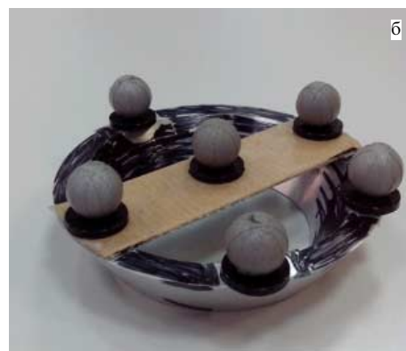
Рис. 2. (а) Эскиз экспериментального образца. (б) Фотография экспериментального образца с размещёнными на нём маркерами системы захвата движения.
