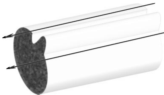
Рис. 2. Возмущение границы плазмы при развитии желобковой неустойчивости. Стрелками показаны силовые линии магнитного поля.
