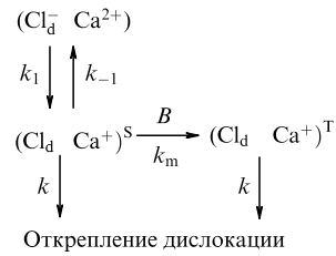
Рис. 2. Схема перемещения дислокаций.
