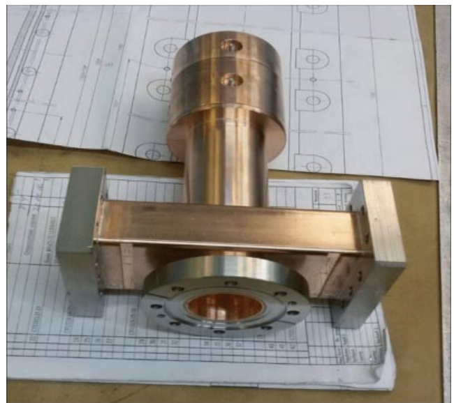
Рис. 3. Импульсная высокочастотная пушка с коаксиальным вводом. На первом плане — выходное отверстие, слева и справа — прямоугольные фланцы для питающего волновода и вакуумного насоса, сзади — два высокочастотных резонатора. Фотокатодом служит задняя стенка дальнего резонатора.
