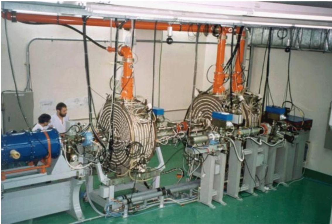
Рис. 1. (В цвете онлайн.) Электронный инжектор. Слева направо: электронная пушка (синий бак), диагностический промежуток, группировочный резонатор, дрейфовый промежуток, в котором происходит группировка, и два ускоряющих резонатора.
