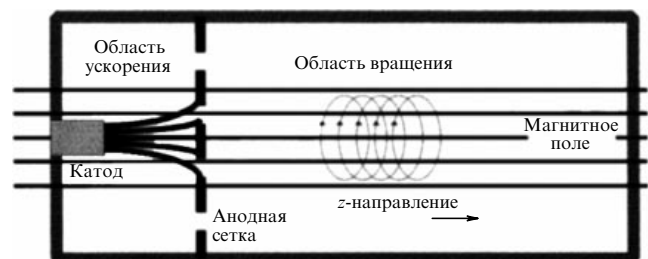
Рис. 5. Элементарная схема вакуумно-дуговой центрифуги [76].
