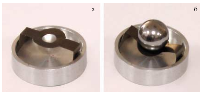
Рис. 10. Подложка столика, предназначенного для изучения движения стального шарика в модели лифта Эйнштейна: (а) пружина не деформирована, (б) шарик лежит на пружине и деформирует её.
