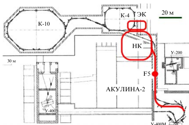
Рис. 57. Возможное размещение накопительного кольца (НК) К5 и электронного накопительного кольца (ЭК) для электрон–РИ-коллайдера. Схема показана на фоне чертежей проекта К4–К10 от 1989 г. и плана существующих зданий циклотронов У-400М, У-400, У-200 в ЛЯР ОИЯИ.
