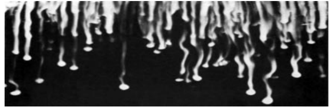
Рис. 1. Ансамбль термиком в форме тяжёлых солевых пальцев, опускающихся в водяном слое, согласно [21]. Нисходящее движение термиком визуализируется добавлением в соль флуоресцеина и освещением через щель.
