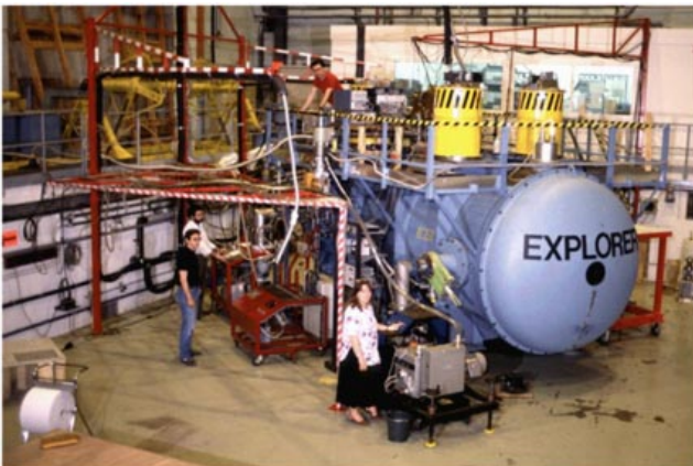
Рис. 3. Резонансный детектор Explorer (ЦЕРН, Швейцария).
