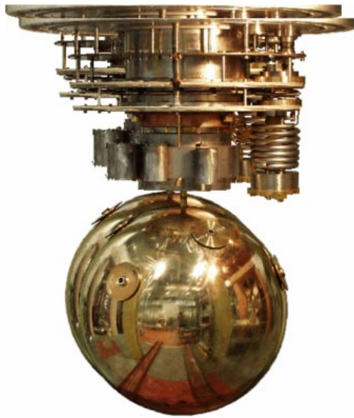
Рис. 7. Сферическая антенна с изотропной диаграммой приёма гравитационного излучения MiniGRAIL (Лейденский университет, Лаборатория им. Камерлинг-Оннеса) (Нидерланды).
