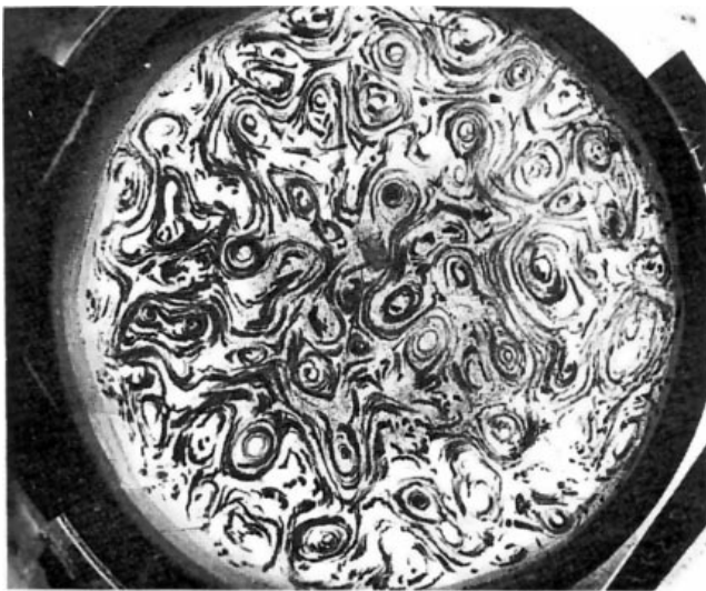
Рис. 3. Система нерегулярных конвективных вихрей на вращающейся платформе при большей, чем на рис. 2, скорости вращения. (Из монографии [12].)
