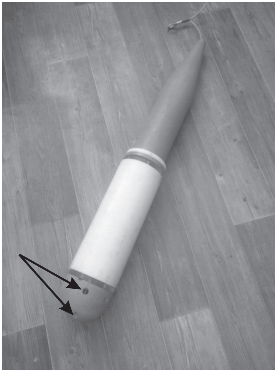
Рис. 2. Макет зонда с положительной (5 кгс) плавучестью. Черными стрелками показаны датчики давления и температуры.
