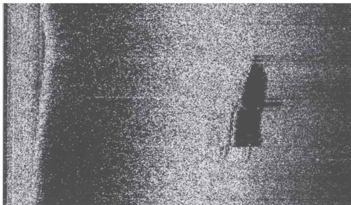
Рис. 3. Гидролокационное изображение дна, выполненное в районе местонахождения АПЛ “Комсомолец”, с помощью ГБА “Звук”.
