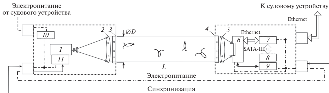
Рис. 3. Функциональная схема МЦГМ. 1 – Лазер, 2 – оптическая система для формирования зондирующего пучка, 3, 4 – иллюминатор, 5 – приемная оптическая система, 6 – Smart камера, 7 – устройство управления погружной частью, 8 – дисковый накопитель, 9 – система синхронизации, 10 – контроллер электропитания погружной части макета, 11 – драйвер управления лазером.
