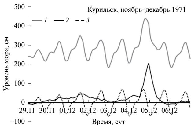
Рис. 6. Графики вариаций суммарного уровня (1), непериодической (2) и приливной компонент (3) по измерениям на станции Курильск за 29.11–6.12.1971 г.
