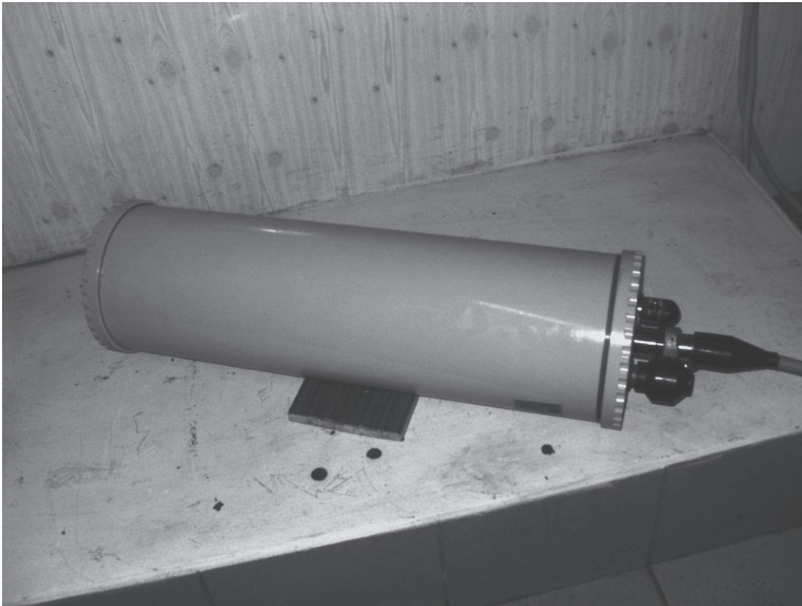
Рис. 4. Внешний вид корпуса кабельной донной сейсмостанции КДСС-1 на постаменте в испытательном бункере ОКБ ОТ РАН.
