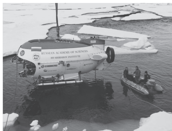
Рис. 1. ГОА “Мир-1” опускается на воду среди льдов Северного полюса.
