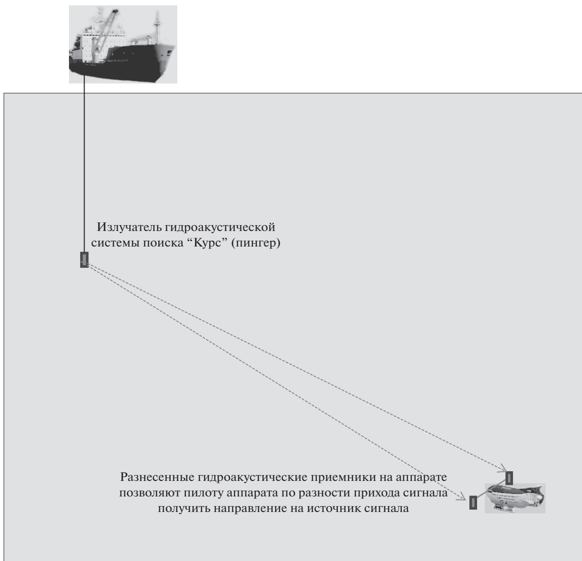
Рис. 5. Принцип работы гидроакустической системы поиска "Курс".
