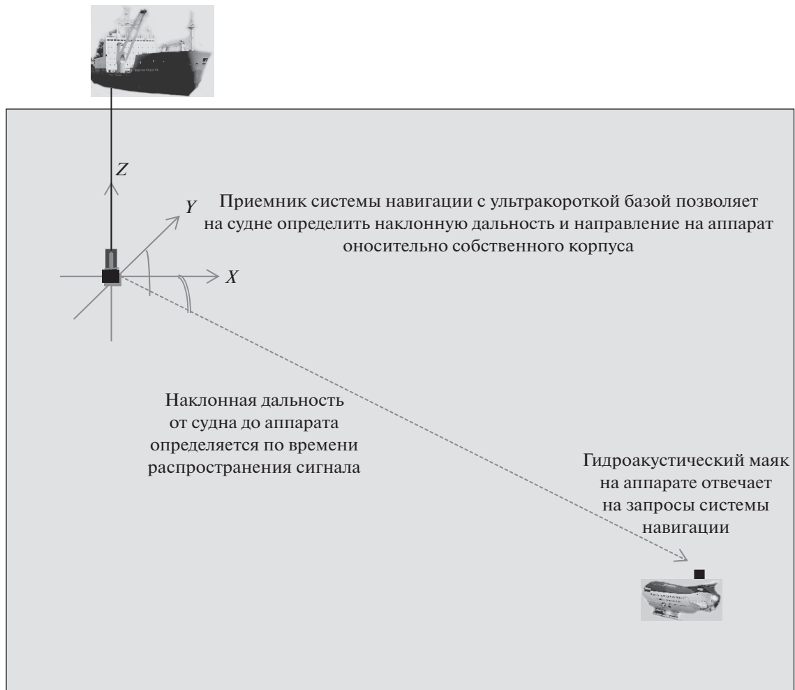
Рис. 4. Принцип работы системы навигации с ультракороткой базой.
