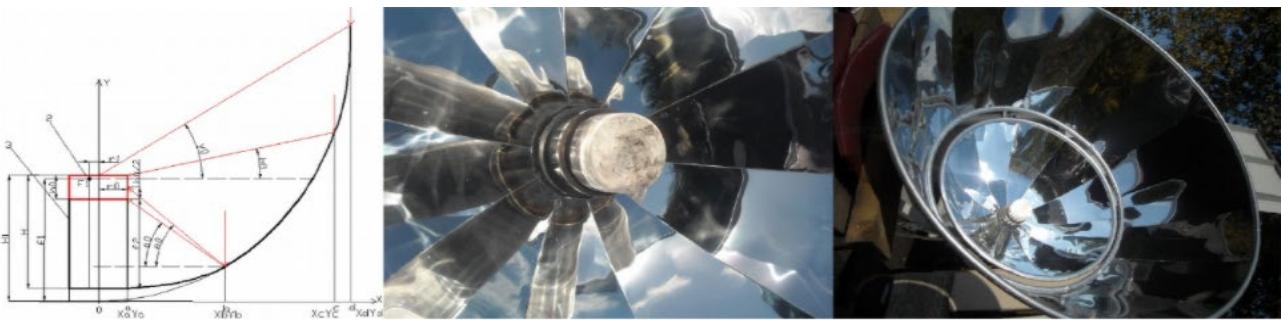
Рис. 12. Схема теплофотоэлектрического солнечного модуля с горячим цилиндром двигателя Стирлинга (слева) и концентраторный солнечный модуль с двигателем Стирлинга (справа) Fig. 12. Scheme of the photovoltaic thermal solar module with the hot cylinder of the Stirling engine (on the left) and the concentrator solar module with a Stirling engine (on the right)
