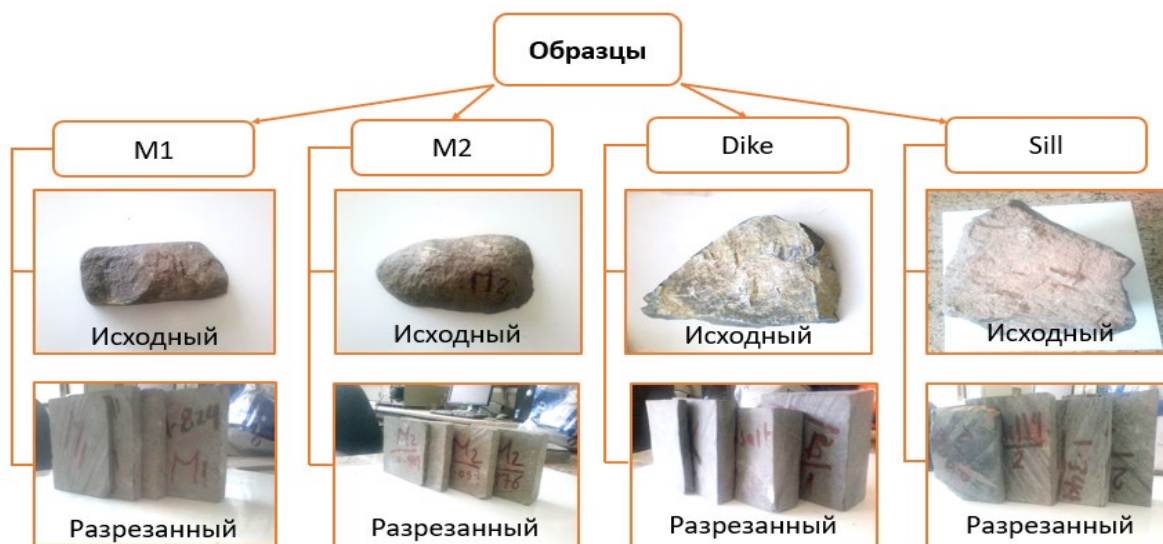
Рис. 2. Исследуемые образцы базальта. Fig. 2. Preparation of the basalt samples.
