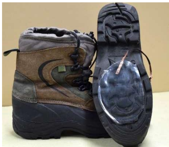
Ботинок с нанесенным на его подошву покрытием, превращающим энергию падающего снега в электричество /©Abdelsalam Ahmed et. al., Nano Energy 2019
