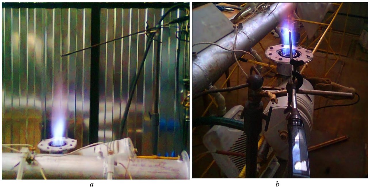
Рис. 10 – Установка пробоотборного устройства (а) и зондирование открытого факела (б) Fig. 10 – An arrangement of sampler and auxiliary facilities (a) and sounding the open flame (b)
