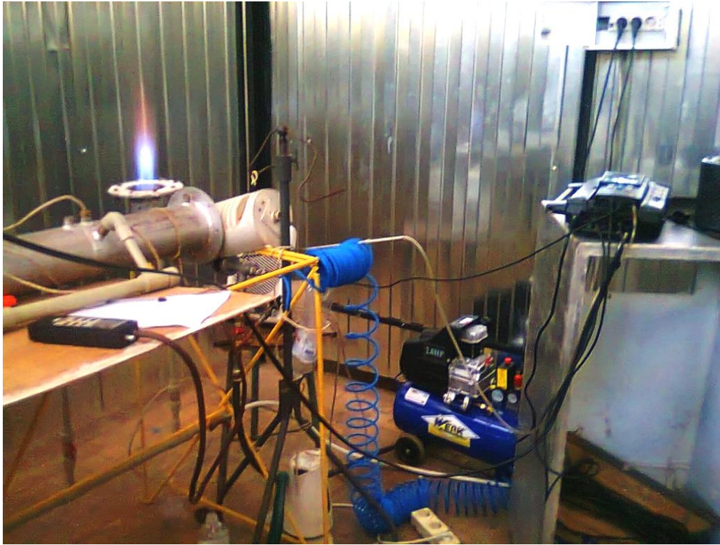
Рис. 8 – Внешний вид экспериментальной установки для исследования влияния влаги на процесс сжигания природного газа в открытом факеле Fig. 8 – External view of experimental set-up for investigation an influence of air flow moisture upon the process of natural gas burning in open flame
