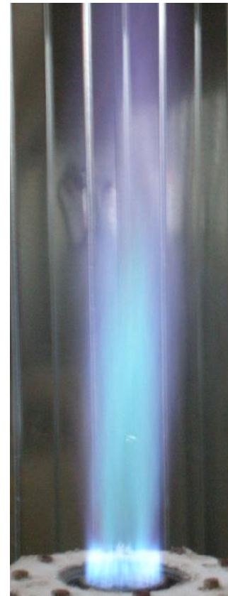
Рис. 11 – Факел при \lambda = 0,7 ; содержание кислорода в смеси [\text{O}_2] = 18,28\%
