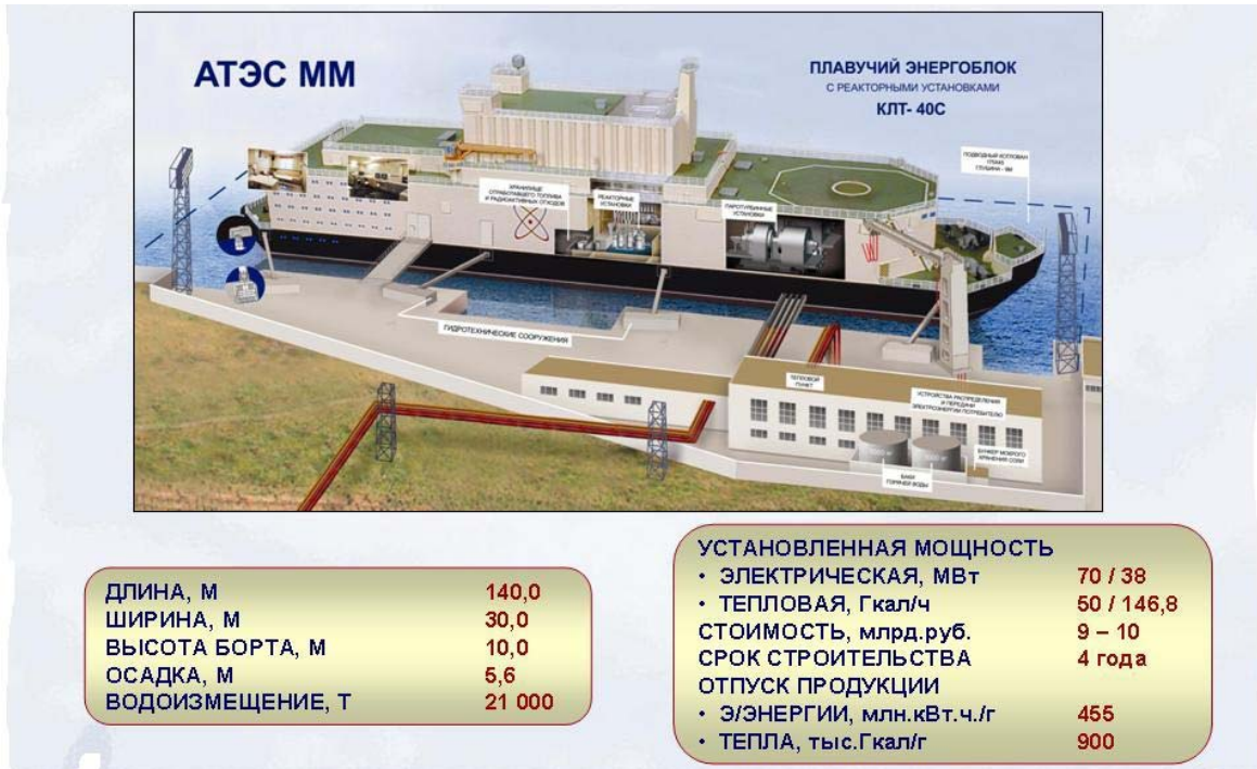
Рис. 2 – Структура и характеристики ПАТЭС с АСММ [8] Fig. 2 – Structure and features PATES with ASM [8]
