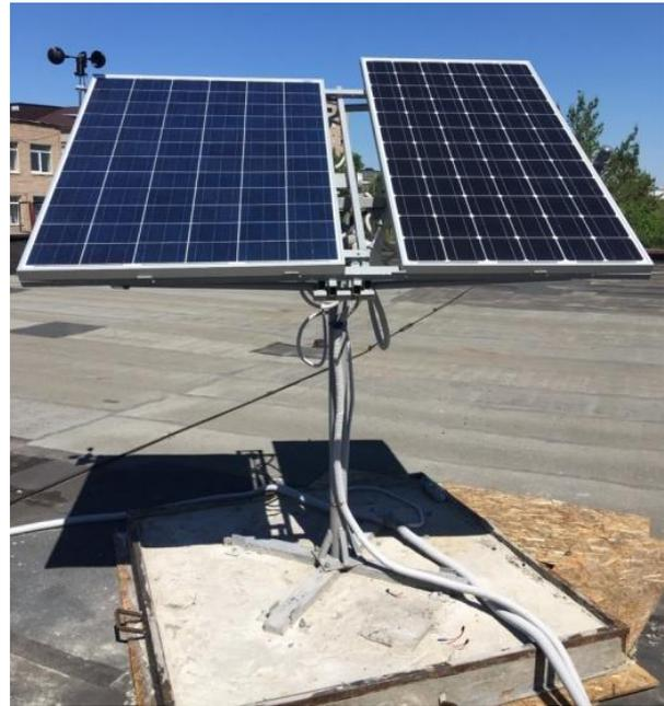
Рис. 2 – Общий вид автоматизированного двухкоординатного солнечного трекера
