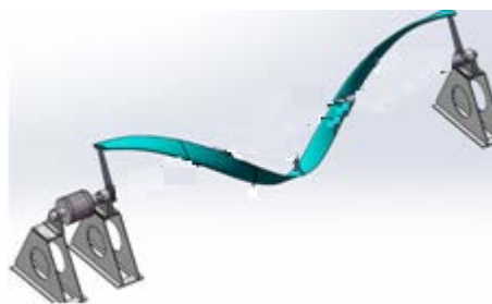
Рис. 2 – Спиральная безвальная турбина с постоянным крутящим моментом на валу [1] Fig. 2 – Spiral shaftless turbine with constant torque on the shaft [1]
