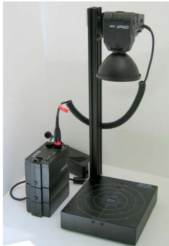
Рис. 5 – Установка измерения времени жизни НЗ «Sinton WCT-120»
