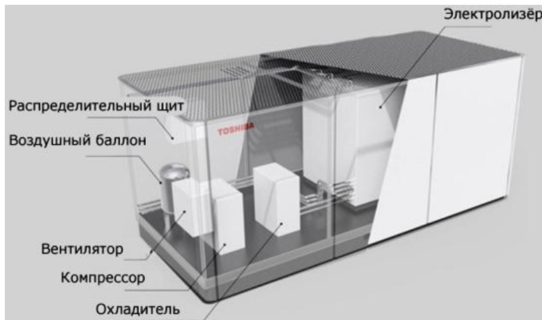
Рис. 6 – Структура ВЭМ по данным фирмы Toshiba (Япония)
